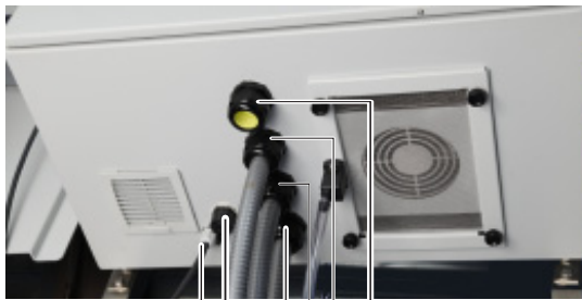
kuva 3-24 Kotelon pohjan liitännät (alapuolelta) Esimerkki: 2 näytekanavaa, 1 tyhjennys
