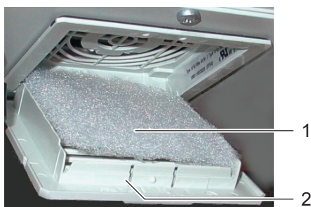
figur 5-16 Udskiftning af den nederste filtermåde
