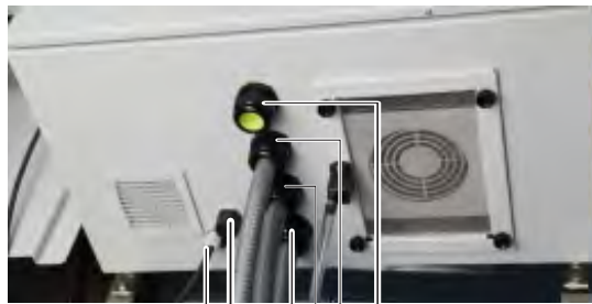
kuva 3-24 Kotelon pohjan liitännät (alapuolelta) Esimerkki: 2 näytekanavaa, 1 tyhjennys
