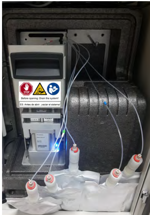
kuva 5-19 ChemBagit poistettu tukitangosta
