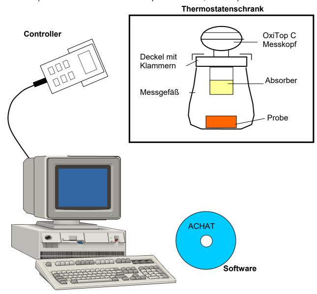
Während der Messung können die Messdaten aller Messstellen beliebig oft in den Controller mittels Infrarot-Schnittstelle übertragen werden. Der Controller bietet zur Überwachung direkt eine graphische Darstellung der Messdaten. Der gesamte Datenbestand lässt sich mit dem Kommunikationsprogramm Achat über die serielle Schnittstelle und das Datenkabel auf einen Computer übertragen
