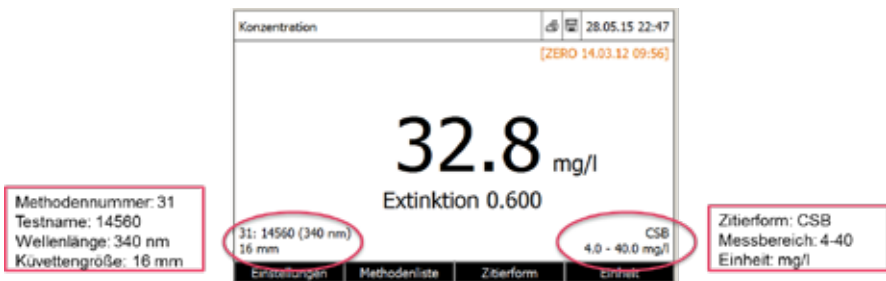
Abb. 10 photoLab 7000 Display: Neben dem gemessenen CSB Messwert werden zusätzliche Informationen angezeigt
