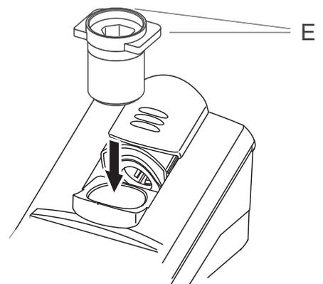
**13 mm-Küvette einsetzen**
