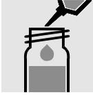
2,5 ml Probe in eine leere Rundküvette pipettieren.
