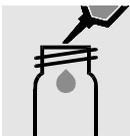
5 ml Probe in eine leere Rundküvette (RK 14/25, WTW Best.-Nr. 250621) pipettieren.
