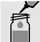
Zur gemessenen Küvette 0,2 ml **H-2K** zupipettieren, mit Schraubkappe verschließen und mischen.
