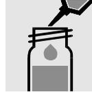
5 ml vorbereitete Probe zupipettieren, mit Schraubkappe verschließen und mischen.
