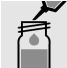
0.5 ml Probe in eine Reaktionsküvette pipettieren, mischen.
