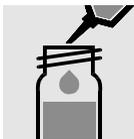
2 ml Probe in eine Reaktionsküvette pipettieren und mischen.
