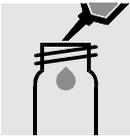
2 ml dest. Wasser in eine leere Rundküvette (Best.-Nr. 250621) pipettieren.
