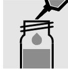
2 ml Probe zupipettieren, mit Schraubkappe verschließen und mischen.
