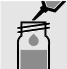
2 ml Probe in eine Reaktionsküvette pipettieren und mischen.
