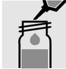
3 ml Probe **vorsichtig** in die Reaktionsküvette pipettieren, mit Schraubkappe fest verschließen und kräftig mischen.
