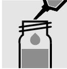
0,2 ml **RH-1K** zupipettieren, mit Schraubkappe verschließen und mischen.
