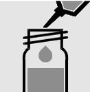
3 ml Probe zupipettieren, mit Schraubkappe verschließen und mischen.
