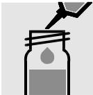
5 ml Probe in eine Reaktionsküvette pipettieren, mischen.
