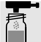
1 Dosis **PO<sub>4</sub>-3** mit blauem Dosierer zugeben, mit Schraubkappe verschließen.
