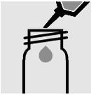
5 ml Probe in ein Glas mit Schraubverschluss pipettieren. **(Wichtig: kein Borsilikatglas verwenden!)**
