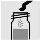
1 grünen Mikrolöffel **Ph-2K** zugeben, mit Schraubkappe verschließen.
