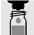
6 Tropfen **Cr-3K** in eine Reaktionsküvette geben, mit Schraubkappe verschließen.
