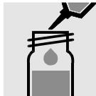
5 ml **Zn-6** (Isobutylmethylketon Mod. 06146, Bestellnr. 250 452) zupipettieren und Glas fest verschließen.
