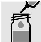
5 ml Probe in eine Reaktionsküvette pipettieren, mischen.
