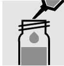
2 ml Probe **vorsichtig** in die Reaktionsküvette pipettieren, mit Schraubkappe fest verschließen und kräftig mischen.
