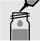
10 ml Probe in eine Reaktionsküvette pipettieren und mischen.
