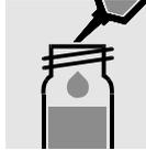
2 ml Probe **vorsichtig** in eine Reaktionsküvette pipettieren, mit Schraubkappe fest verschließen und kräftig mischen.
