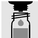
6 Tropfen **Cr-3K** zugeben, mit Schraubkappe verschließen und mischen. 1 Minute stehen lassen.
