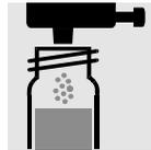
1 Dosis **PO<sub>4</sub>-2** mit grünem Dosierer zugeben, mit Schraubkappe verschließen.
