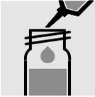
0.5 ml Probe in eine Reaktionsküvette pipettieren, mischen.
