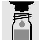
6 Tropfen **Au-5A** zugeben, mit Schraubkappe verschließen.
