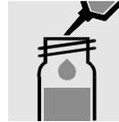
1,5 ml Probe zupipettieren und mischen.
