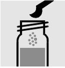
1 blauen Mikrolöffel  $\text{NO}_3\text{-1K}$  in eine Reaktionsküvette geben.
