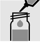
5.0 ml Probe in eine Reaktionsküvette pipettieren und mischen.
