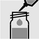
0.1 ml Probe in eine Reaktionsküvette pipettieren und mischen.
