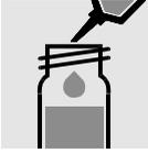
4 ml Probe in eine Reaktionsküvette pipettieren, mischen.
