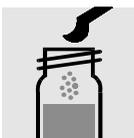
1 blauen Mikrolöffel **N-3K** in eine Reaktionsküvette geben, mit Schraubkappe verschließen.
