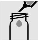
5 ml Probe in eine leere Rundküvette (weiße Schraubkappe) pipettieren.
