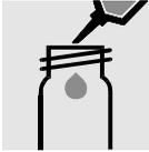
10 ml Probe in eine leere Reaktionsküvette pipettieren. (Leerküvette RK14/25: WTW-Best.Nr. 250621)
