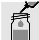
5 ml Probe zupipettieren und mischen.
