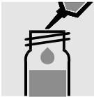
0,2 ml Probe in eine Reaktionsküvette pipettieren und mischen.
