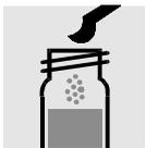
1 grauen Mikro-**löffel Zn-5** zugeben und Feststoff lösen.
