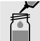
1,5 ml vorbereitete Probe in eine Reaktionsküvette pipettieren.
