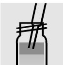
Mit Pasteurpipette klare obere Schicht abziehen.
