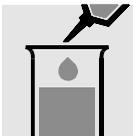
5 ml Probe in eine leere Küvette pipettieren.
