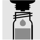
6 Tropfen **N-2K** zugeben, mit Schraubkappe verschließen und mischen.
