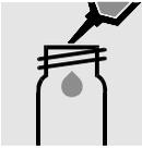
10 ml Probe in eine leere Rundküvette (Best.-Nr. 250621) pipettieren.
