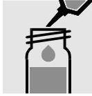
0,2 ml **Mg-1K** zupipettieren, mit Schraubkappe verschließen und mischen.
