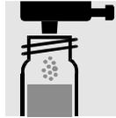
1 Dosis **SO<sub>4</sub>-1K** mit grünem Dosierer zugeben, mit Schraubkappe verschließen.
