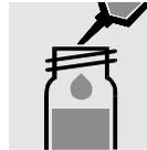
1,5 ml **B-2A** zupipettieren und Glas verschließen.
