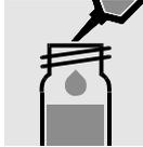
2 ml Probe **vorsichtig** in eine Reaktionsküvette pipettieren, mit Schraubkappe fest verschließen und kräftig mischen.
