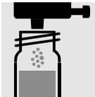
1 Dosis **PO<sub>4</sub>-3** mit blauem Dosierer zugeben, mit Schraubkappe verschließen.
