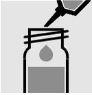
1 ml Probe in eine Reaktionsküvette pipettieren, mischen.
