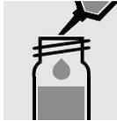
5 ml Probe zupipettieren, mit Schraubkappe verschließen und mischen.
