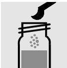
1 grauen Mikrolöffel **Pb-2K** zu der bereits gemessenen Küvette geben, mit Schraubkappe verschließen.
