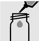
5 ml dest. Wasser in eine leere Rundküvette (RK14/25, WTW Best.-Nr. 250621) pipettieren und mischen.
