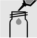
5 ml Probe in ein Glas mit Schraubverschluß pipettieren. (**Wichtig: kein Borsilikatglas verwenden!**)
