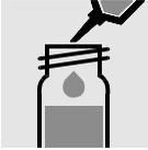
5 ml dest. Wasser in ein Glas mit Schraubverschluss pipettieren.
