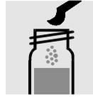
1 grünen Mikrolöffel **Cd-2K** zugeben, mit Schraubkappe verschließen.
