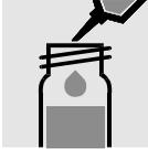
5 ml Probe in eine Reaktionsküvette geben, **nicht mischen!**
