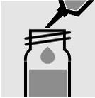
0.5 ml Probe in eine Reaktionsküvette pipettieren und mischen.
