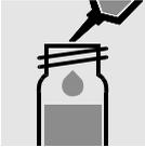
5 ml Probe in eine Reaktionsküvette pipettieren und mischen.
