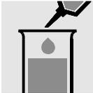
5 ml destilliertes Wasser in ein leeres Reagenzglas pipettieren.
