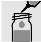
0,2 ml **H-1K** zupipettieren, mit Schraubkappe verschließen und mischen.
