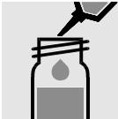
5 ml Probe in ein Glas mit Schraubverschluß pipettieren.
