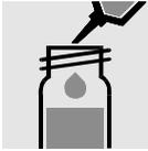
5 ml Probe in eine Reaktionsküvette pipettieren und Feststoff lösen.
