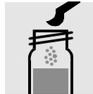
1 blauen Mikrolöffel **CN-3K** zugeben, mit Schraubkappe verschließen.
