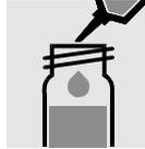
1,5 ml Probe zupipettieren, mit Schraubkappe fest verschließen und mischen.
