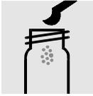
1 blauen Mikrolöffel **NO<sub>3</sub>-1A** in eine leere, trockene Rundküvette (RK 14/25, WTW Best.-Nr. 250 621) geben.
