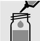
5 ml der vorbereiteten Probe in eine Reaktionsküvette pipettieren und Feststoff lösen.
