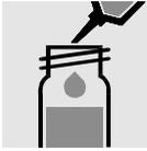
5 ml Probe in eine Reaktionsküvette pipettieren und mischen.
