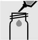
5 ml Probe in eine leere Rundküvette pipettieren.
