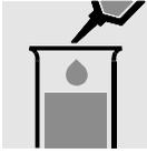
5 ml Probe in ein Reagenzglas pipettieren.
