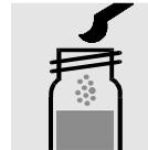
1 grauen Mikrolöffel **Pb-2K** zugeben, mit Schraubkappe verschließen.
