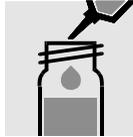
1 ml Probe **vorsichtig** in die Reaktionsküvette pipettieren, mit Schraubkappe fest verschließen und kräftig mischen.
