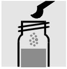
1 blauen Mikrolöffel **K-2K** zugeben, mit Schraubkappe verschließen.
