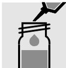
0,5 ml Probe in eine Reaktionsküvette pipettieren, nicht mischen.
