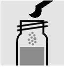
1 grünen Mikrolöffel **HCHO-1K** in eine Reaktionsküvette geben, mit Schraubkappe verschließen.
