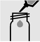
0.5 ml Probe in eine leere Rundküvette (RK 14/25, WTW-Best.-Nr. 250 621) pipettieren.
