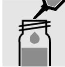
**Sofort** 2.0 ml Probe zupipettieren, mit Schraubkappe verschließen und mischen.
