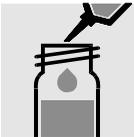
5 ml Probe der vorbereiteten Probe in eine Reaktionsküvette pipettieren.
