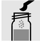
1 blauen Mikrolöffel **CN-3K** zugeben, mit Schraubkappe verschließen.
