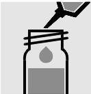
1.5 ml Probe in eine Reaktionsküvette pipettieren.
