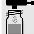
1 Dosis **CN-1K** mit grünem Dosierer zugeben, mit Schraubkappe verschließen.
