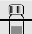
Küvette aus dem Thermoreaktor nehmen, im Rundküvettenständer auf Raumtemperatur abkühlen lassen.
