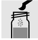
1 blauen Mikro­löfel **Fe-1K** zugeben, mit Schraubkappe verschließen.
