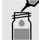
1,5 ml **B-2A** zupipettieren und Glas verschließen.
