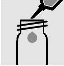
10 ml Probe in eine leere Rundküvette (RK 14/25, WTW-Best.-Nr. 250 621) pipettieren.
