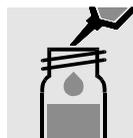
1,5 ml vorbereitete Probe zupipettieren, mit Schraubkappe fest verschließen und mischen.
