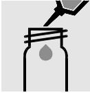
5 ml dest. Wasser in ein leeres Glas mit Schraubverschluß pipettieren. (**Wichtig: kein Borsilikatglas verwenden!**)
