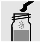
1 grünen Mikrolöffel **Ph-2K** zugeben, mit Schraubkappe verschließen.
