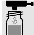
1 Dosis **P-1K** mit grünem Dosierer zugeben, mit Schraubkappe verschließen.
