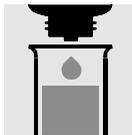
1 Tropfen **Ni-1A** zugeben und mischen. Bei Entfärbung der Lösung ist die Dosierung des Reagenzes tropfenweise zu erhöhen, bis eine schwache Braunfärbung bestehen bleibt.
