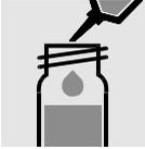
4 ml Probe in eine Reaktionsküvette pipettieren, mischen.
