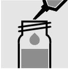
4 ml Probe in eine Reaktionsküvette pipettieren und mischen.
