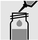
0,2 ml **Mg-2K** zupipettieren, mit Schraubkappe verschließen und mischen.
