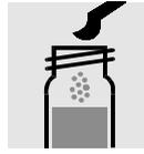
1 grünen Mikro­löf­fel **SO<sub>4</sub>-2A** zugeben und Feststoff lösen.
