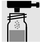
1 Dosis **PO<sub>4</sub>-2** mit grünem Dosierer zugeben, mit Schraubkappe verschließen.
