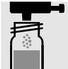
1 Dosis **P-3K** mit blauem Dosierer zugeben, mit Schraubkappe verschließen.
