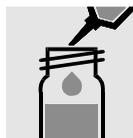
1 ml Probe in eine Reaktionsküvette pipettieren und mischen.
