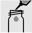
10 ml Probe in eine leere Rundküvette (RK 14/25, WTW Best.-Nr. 250621) pipettieren.
