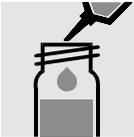
5 ml **Zn-6** (Isobutylmethylketone Mod. 06146, Bestellnr. 250 452) zupipettieren und Glas fest verschließen.
