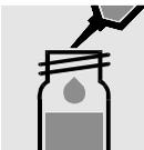
6 ml **Au-4A** zu-pipettieren und mit Schraubkappe verschließen.
