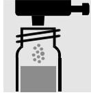
1 Dosis  $\text{PO}_4\text{-3}$  mit blauem Dosierer zugeben, mit Schraubkappe verschließen.
