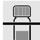
Küvette aus dem Thermoreaktor nehmen, im Rundküvettenständer auf Raumtemperatur abkühlen lassen.
