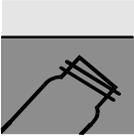
Küvette luftblasenfrei (!) vollständig mit Wasserprobe füllen.
