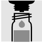
2,5 ml **SO<sub>4</sub>-3A** zupipettieren und mischen.
