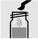
1 blauen Mikrolöffel  $\text{NO}_3\text{-1K}$  in eine Reaktionsküvette geben, mit Schraubkappe verschließen.
