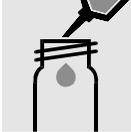
3 ml **HCHO-1** in eine leere Rundküvette (RK 14/25, WTW-Best.-Nr. 250 621) pipettieren.
