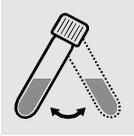
Bodensatz in der Küvette durch Umschwenken in Schwebelage bringen.
