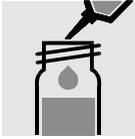
2,5 ml Probe in eine leere Rundküvette (RK 14/25, WTW-Best.-Nr. 250 621) pipettieren.
