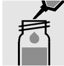
3.5 ml destilliertes Wasser zupipettieren.
