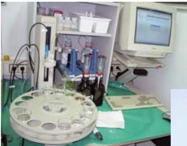
Komplett ausgestatteter Titrationsmessplatz mit Probenwechsler und PC
