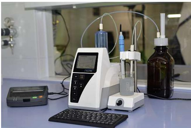
3 Titroline 5000 bei der Titration von NaCl in Kaviar
