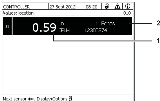
Fig. 3-4 Visualización del valor medido con los valores medidos principal y secundario
